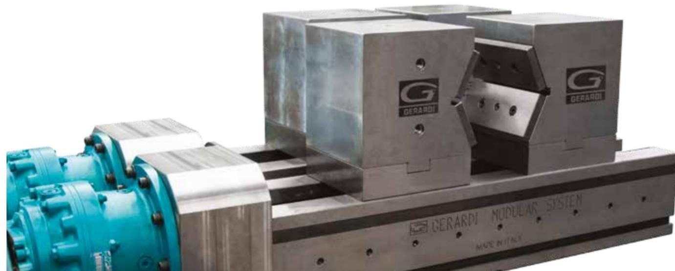
Tubi e cavi di collegamento elettrici ed idraulici con massima lunghezza 1600 mm / Hydraulic pipes and electrical cables with max lenght 1600 mm
