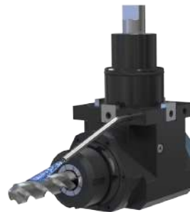
Lubrorefrigerazione esterna tradizionale Standard flood cooling
