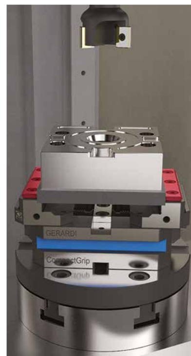
Tramite l'inserto Grip si esegue la sgrossatura e la finitura del pezzo sui cinque lati. Through the Grip insert you can rough mill and finish the workpiece on five sides.
